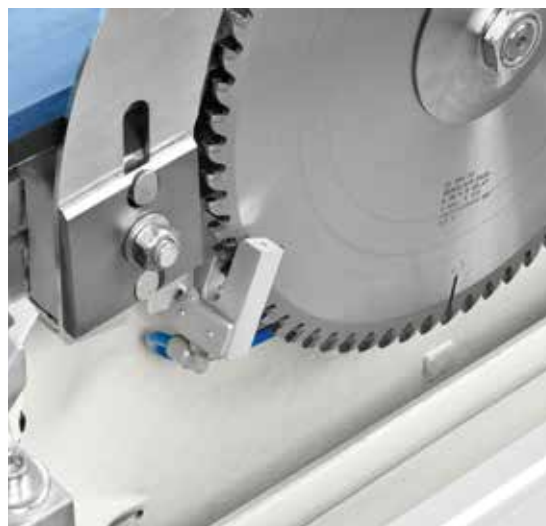
Dispositif de micro-lubrification de la lame Obligatoire pour l'usinage de métaux légers, très utile avec les matières plastiques spéciales.
