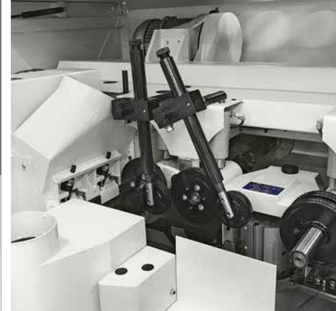
Presseurs verticaux avec roue folle positionnés devant les arbre universels Efficace dans toute situation.
