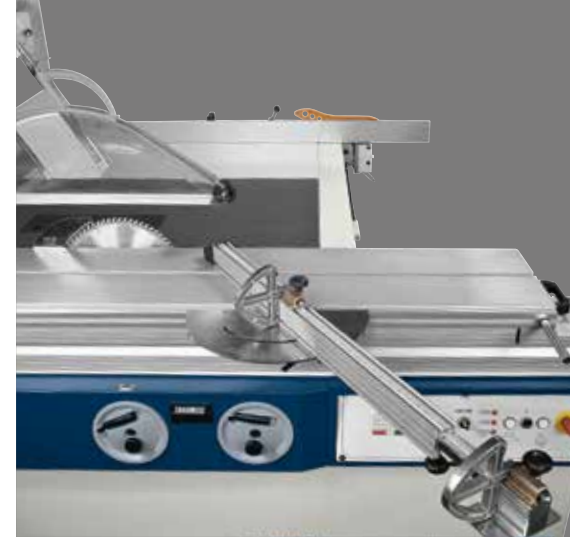
Dispositif pour coupes angulaires composé de: - un guide télescopique avec deux butées réversibles - lunettes avec un système de sélection rapide de l'angle
