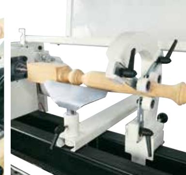
**Lunette Fixe** utilisée pour réduire les vibrations des pièces longues et fines. La forme en « C » permet le passage d'un outil.
