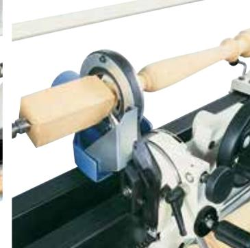
**Lunette Mobile** avec outil de pré-coupe pour toujours garantir une excellente finition de la pièce en usinage.
