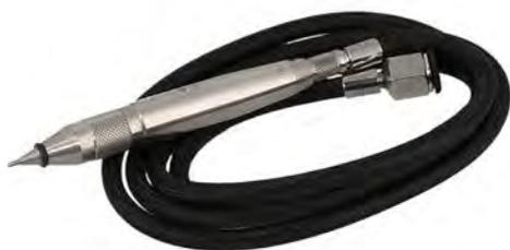
CORPS MÉTALLIQUE Ø 17 MM L140MM. EQUIPÉ D'UNE VANNE MARCHE ARRÊT. TUYAU PU RECOUVERT DE TEXTILE Ø 6 MM X 1500 MM. COUPLEUR ¼". PRESSION DE TRAVAIL DE 2 À 8 BARS. NE S'UTILISE QUE SUR ACIER.
