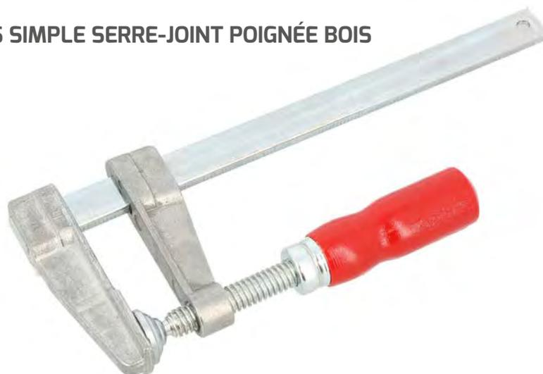
FILETAGE ZINGUÉ. POIGNÉE STRIÉE EN BOIS. TÊTE ET COULISSEAU EN FONTE MODULAIRE. TÊTE EMMANCHÉE À CHAUD ET VERROUILLÉE SUR LA BARRE EN ACIER ZINGUÉE. BARRE CRANTÉE POUR UN MEILLEUR BLOCAGE DU COULISSEAU.
