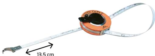
BOÎTIER ACIER RECOUVERT DE SKAI. RUBAN ACIER LAQUÉ BLANC. UNE FACE GRADUÉE EN MM POUR LA CIRCONFÉRENCE, L'AUTRE FACE EN MM POUR LE DIAMÈTRE. MANIVELLE ESCAMOTABLE.
