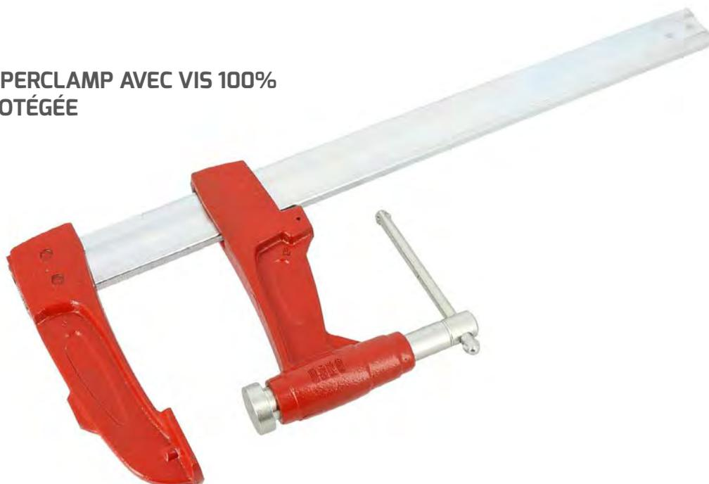
LES EFFORTS SUR LE LEVIER DE SERRAGE SONT TRANSMIS AVEC 80% D'EFFICACITÉ GRÂCE AU SYSTÈME DE TRANSMISSION DE LA PUISSANCE (VOIR PHOTO DÉTAIL). POUR ATTEINDRE LA PRESSION DE SERRAGE, IL FAUT FOURNIR MOINS D'EFFORT. GRANDE DOUCEUR DE FONCTIONNEMENT. PUISSANCE DE SERRAGE : 13000 Nm. SAILLIE 125 MM. SECTION 40 X 10 MM.
