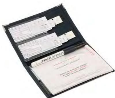
POCHETTE COMPRENANT : 3 JAUGES POUR FISSURE REF. 132500, 1 FISSUROMÈTRE REF. 132510, 1 STYLO, LES NOTICES D'UTILISATION.
