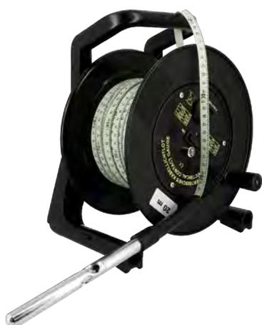
MESURE LA DISTANCE SOL-EAU DANS UN PUIITS. RUBAN EN POLYAMIDE
