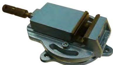
MORS EN ACIER TREMPÉ RECTIFIÉ RÉVERSIBLES. MÂCHOIRE FIXE : 1 FACE LISSE, AUTRE FACE STRIÉE. MÂCHOIRE MOBILE : 1 FACE RAINURÉE EN V VERTICALES ET HORIZONTALES, L'AUTRE FACE LISSE. FIXATION LATÉRALE. PROTECTION DE LA VIS DE SERRAGE.
