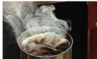
02. L'auto-échauffement est assez important pour mener à l'emballement thermique. L'emballement thermique fait naître un feu couvant.
