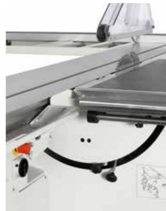
L'inciseur est réglable de l'extérieur, sans besoin de clés, assurant ainsi un positionnement rapide et précis sans jeux.
